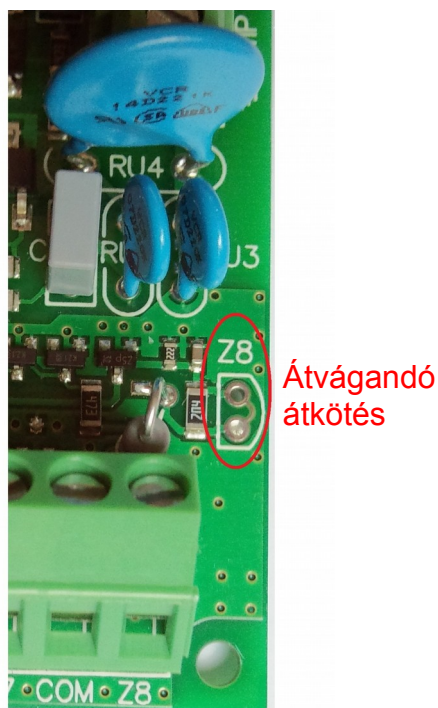
25. ábra: NC S&W redőny és ablak érzékelőhöz átvágandó átkötés (PAS832 v1.07)
